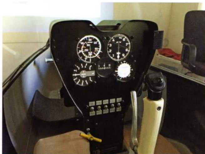
Simulatorens cockpit med fungerende instrumenter og brems/pind/kobling osv. (foto: MSF)
